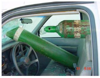
Vor dem Verstauen der Druckgasflaschen im PKW prüfen, dass die Ventile dicht geschlossen sind.
